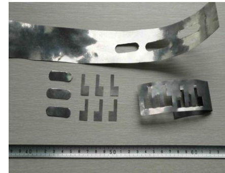
图 6-3 冲压 0.05mm 厚 Fe-6.5%Si 冷轧薄板
