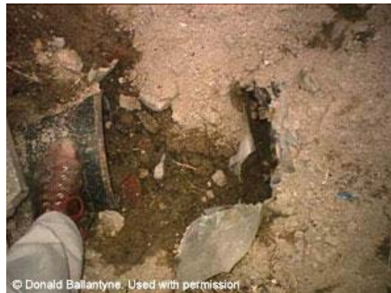
Figura 16-10: Grietas en el suelo (izquierda) y separación de la junta en una tubería de hierro dúctil (derecha) debido a la licuefacción durante el terremoto de Kobe en 1995
