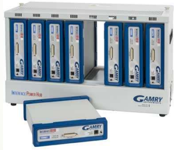
Interface 1010E Galvanostat/ZRA from Gamry
